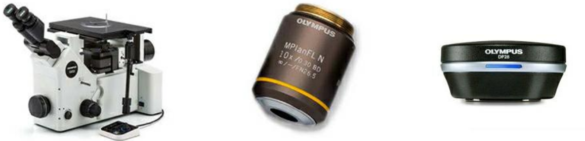
Configuración típica del equipo: Microscopio metalúrgico invertido, lente de objetivo de 10X y una cámara microscópica digital de alta resolución
